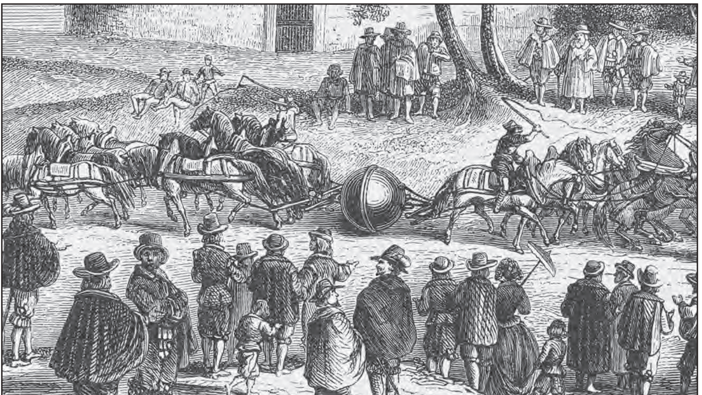
Das Experiment der "Magdeburger Halbkugeln" von Otto von Guericke im Jahre 1657 – Man entzog der Kugel Luft mit einer Pumpe, so dass in der Kugel kein Luftdruck mehr vorhanden war (Vakuum). Der äußere Luftdruck drückte die beiden Halbkugeln so stark zusammen, dass sie sich selbst mit Hilfe der Zugkraft von 16 Pferden nicht trennen ließen.
