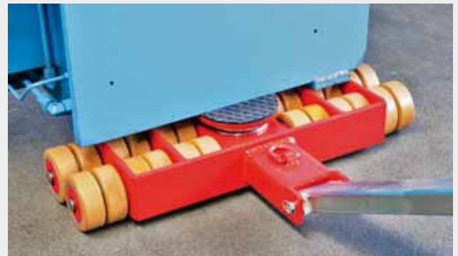
Lenkwerk der G-Serie im Einsatz
