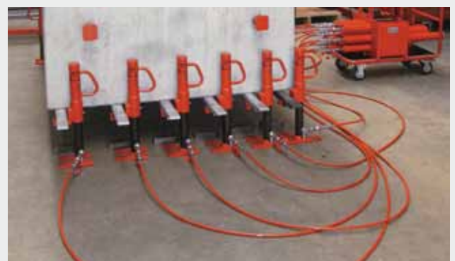
Sonderdruckblock zum synchronen Anheben mit 12 Hebeegeräten Customised solution pressure block for lifting with 12 jacks
