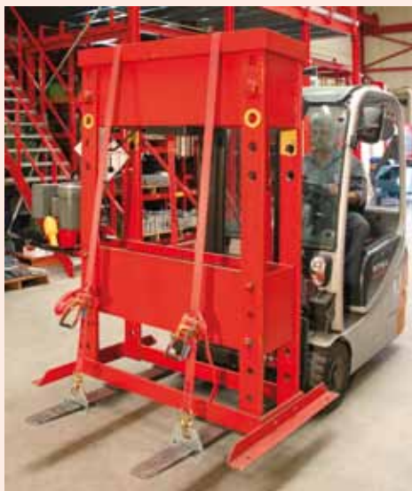
Ladungssicherung mit Gabelklemmen und Spanngurten
