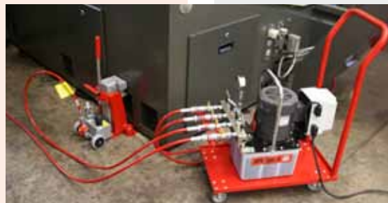
Elektropumpe JPE 30 NVR mit 2 Hebegeräten im Einsatz
