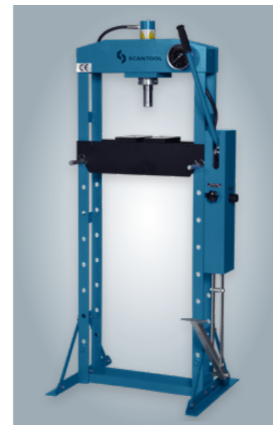
SCANTOOL WSP 15F Værkstedspresere, fod- og håndbetjente - 15 ton Workshop Presses, foot- and handoperated - 15 ton Werkstattpressen, fuss- und handbediente - 15 ton
