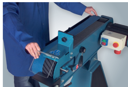
Båndskifte uden brug af værktøj / Belt change without tools / Bandwechsel ohne Werkzeug
