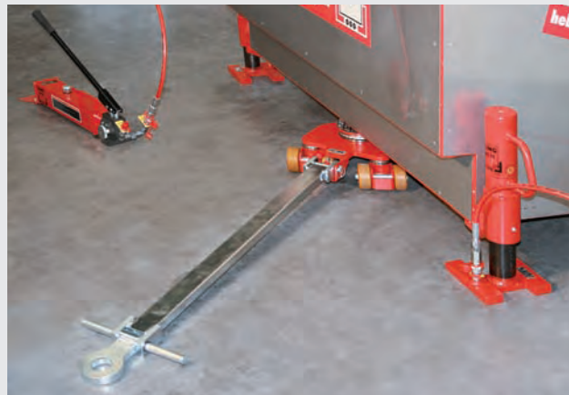
Применение в качестве управляемой тележки
