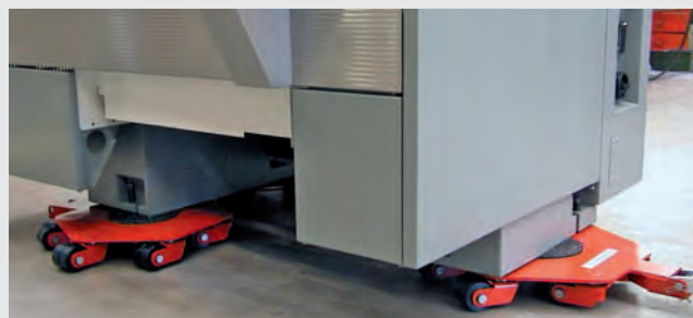
Поворотная платформа JKB в работе Revolving trolley JKB in action
