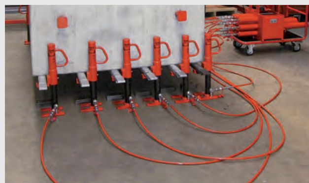
Индивидуальное решение для подъема 12-ю домкратами Customised solution pressure block for lifting with 12 jacks
