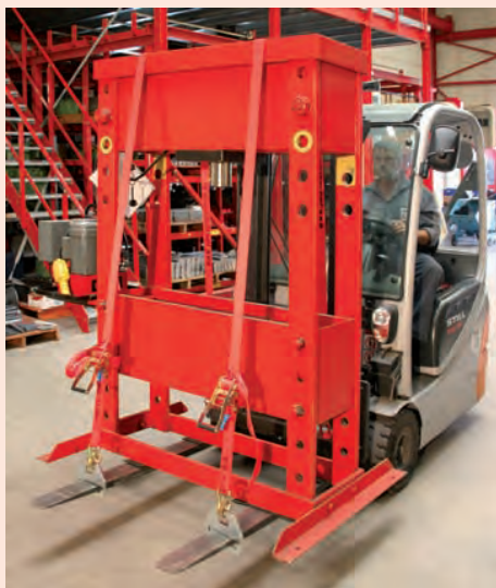
Фиксация груза с помощью захватов и ремней.
