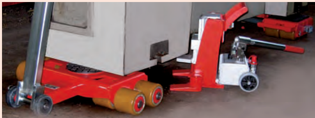
Подшипники гарантируют легкое перемещение Castors with ball bearings guarantee easy movement
