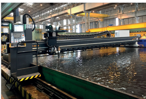
Plasma cutting on a water cutting table Corte por plasma en bancada de agua
