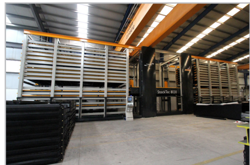
Automatic Plate Storage (STOCKTEC®) Almacén automático de chapa
