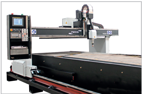
Control centre with touch screen Centro de control con pantalla táctil
