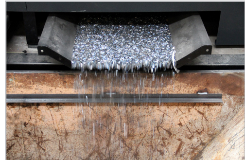
Dross removal Detalle extracción de escoria
