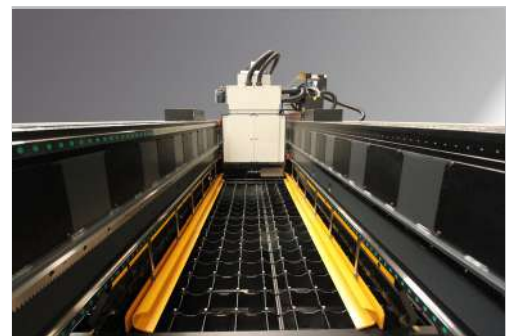
Vertical clamps and metal supports view Detalle del grupo de pisones y apoyos metálicos
