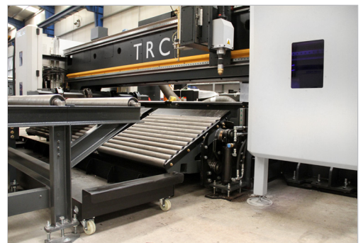
Pieces extraction automatic hatch Trampilla automática de extracción de piezas
