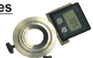
digitaler Verdrehwinkelmesser digital goniometer
