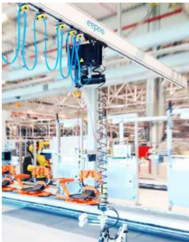
Bild oben: Kranprofil XL mit Handlingsgerät Above: crane profile XL with handling unit
