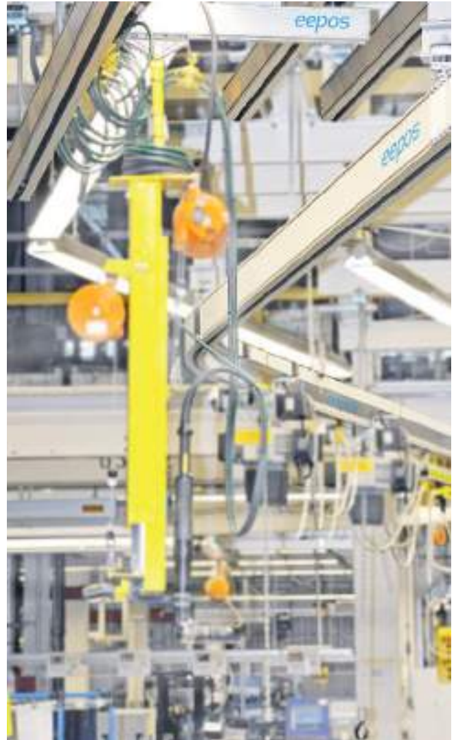
Bild oben: Kranprofil XL mit Handlingsgerät Above: crane profile XL with handling unit
