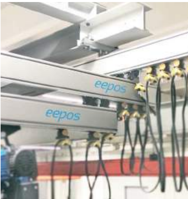
Bild unten: Starraufhängung beim Teleskop-Einträgerkran Below: Rigid mounting at telescopic single girder crane
